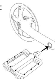
**Step 2.** Ziehen Sie die Pedale mit dem 16-mm-Schraubenschlüssel
