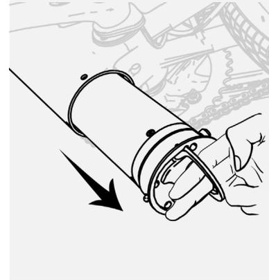
**Schritt 2.** Verbinden Sie die Ladegerät zum Stecker fest
